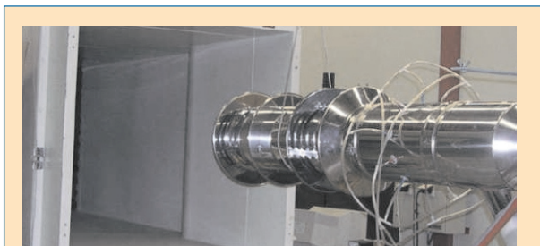
Analýza prietoku vzduchu DINAG zakončenia v GASTEC laboratóriu.
